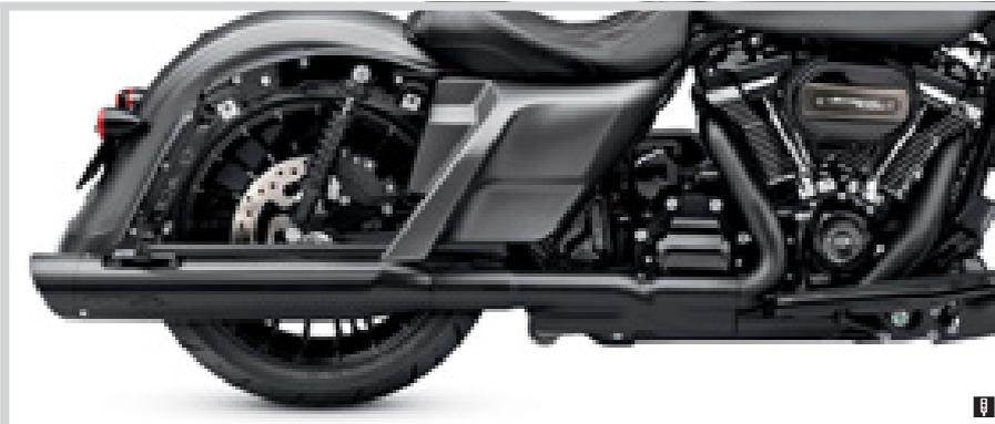
C. SCREAMIN' EAGLE HIGH-FLOW EXHAUST SYSTEM WITH STREET CANNON MUFFLERS – SATIN BLACK (SHOWN WITH TWO-PIECE MUFFLER END CAPS)
